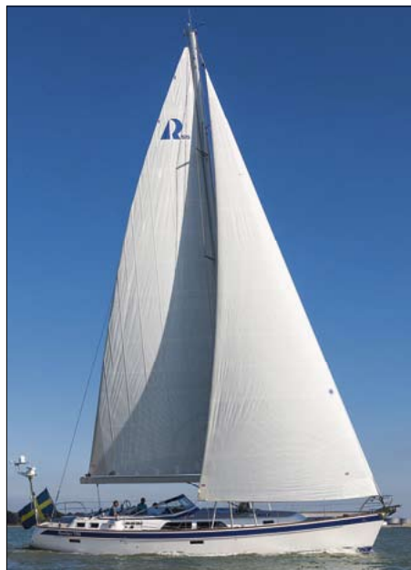
▲ Notez la chute arrondie de la grand-voile, rendue possible par les lattes verticales Elvström.
