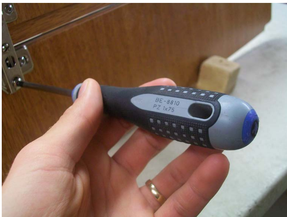
Skruvmejsel för stjärnmejsel ( se måttangivelse)
