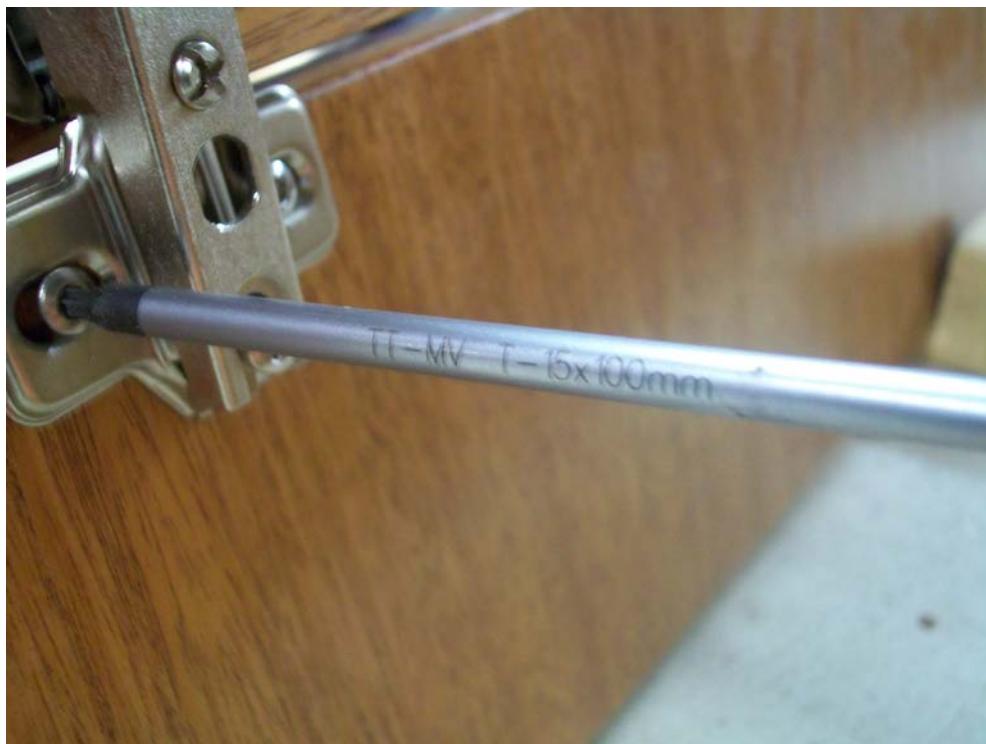
Skruvmejsel för torx ( se måttangivelser)
