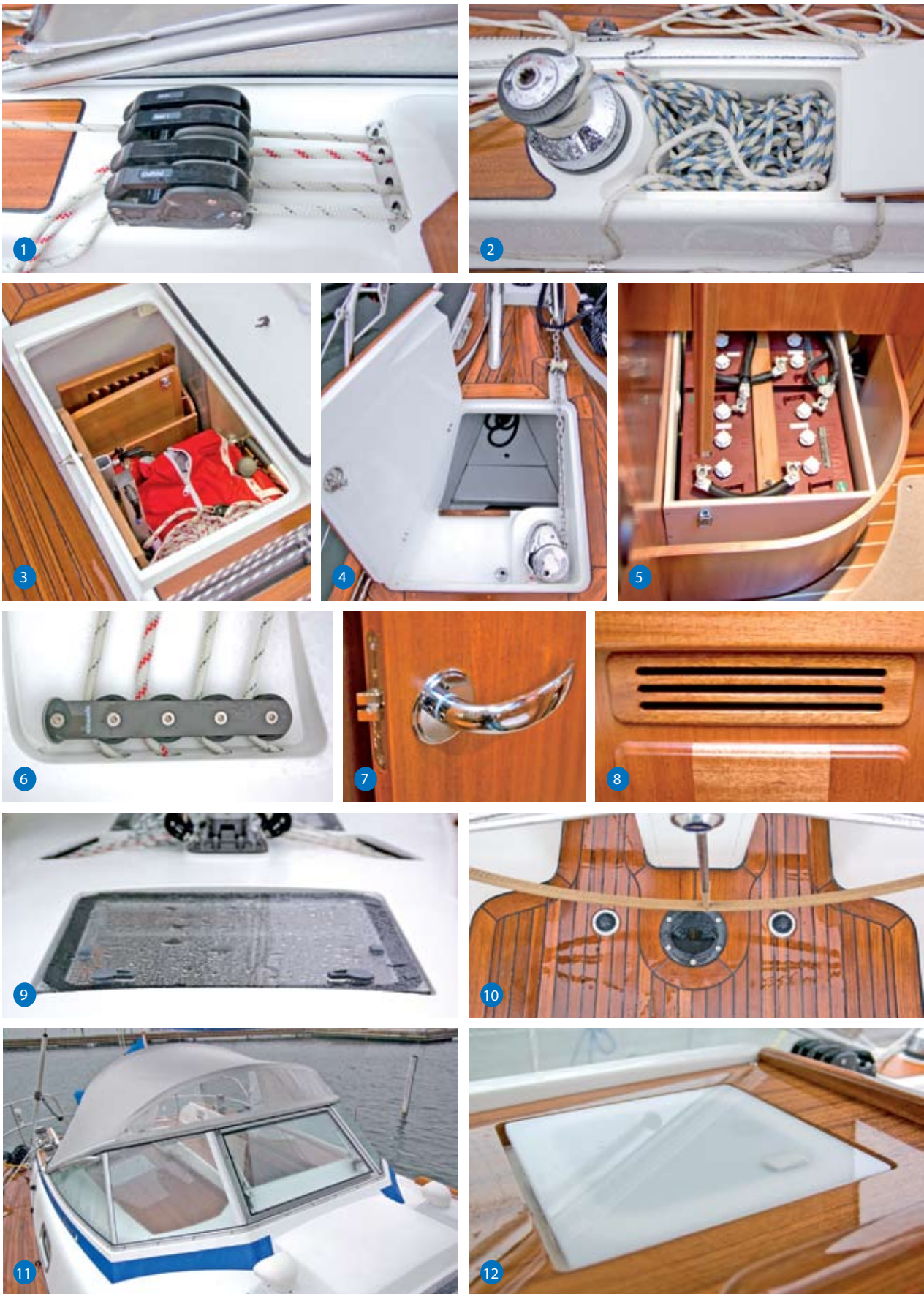
Schöne Details: 1. Fallen und Strecker werden verdeckt auf die vorderen Süllwischen geführt, die auch zum Holen der Großschot dienen („German Cupper Main Sheet System“). 2. Leinenkästen hinter den Winschen; 3. geräumige Backskisten mit praktischen Fächern; 4. perfekt ausgelegter Ankerkasten; 5. durchdachte Batterielagerung; 6. Leinenführung unter dem Kajütdach; 7. formschöne Türbeschläge (Exklusivanfertigung); 8. Hinterlüftungsgitter an allen Schränken und Schapps; 9. Flushluks auf dem Aufbau; 10. Fußschalter für das Bugstrahlruder am Steuerstand; 11. feste Scheiben mit zu öffnendem Mittelteil; 12. Milchglas-Flushluks im Bereich der großzügigen Ablagen neben dem Niedergang.
