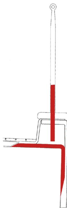
Rumpf und Deck sind bei allen Modellen sorgfältig zusammen-laminiert. Die Seerelingsstützen werden ab 37 Fuss auf der Fussre-lingsüll montiert.
