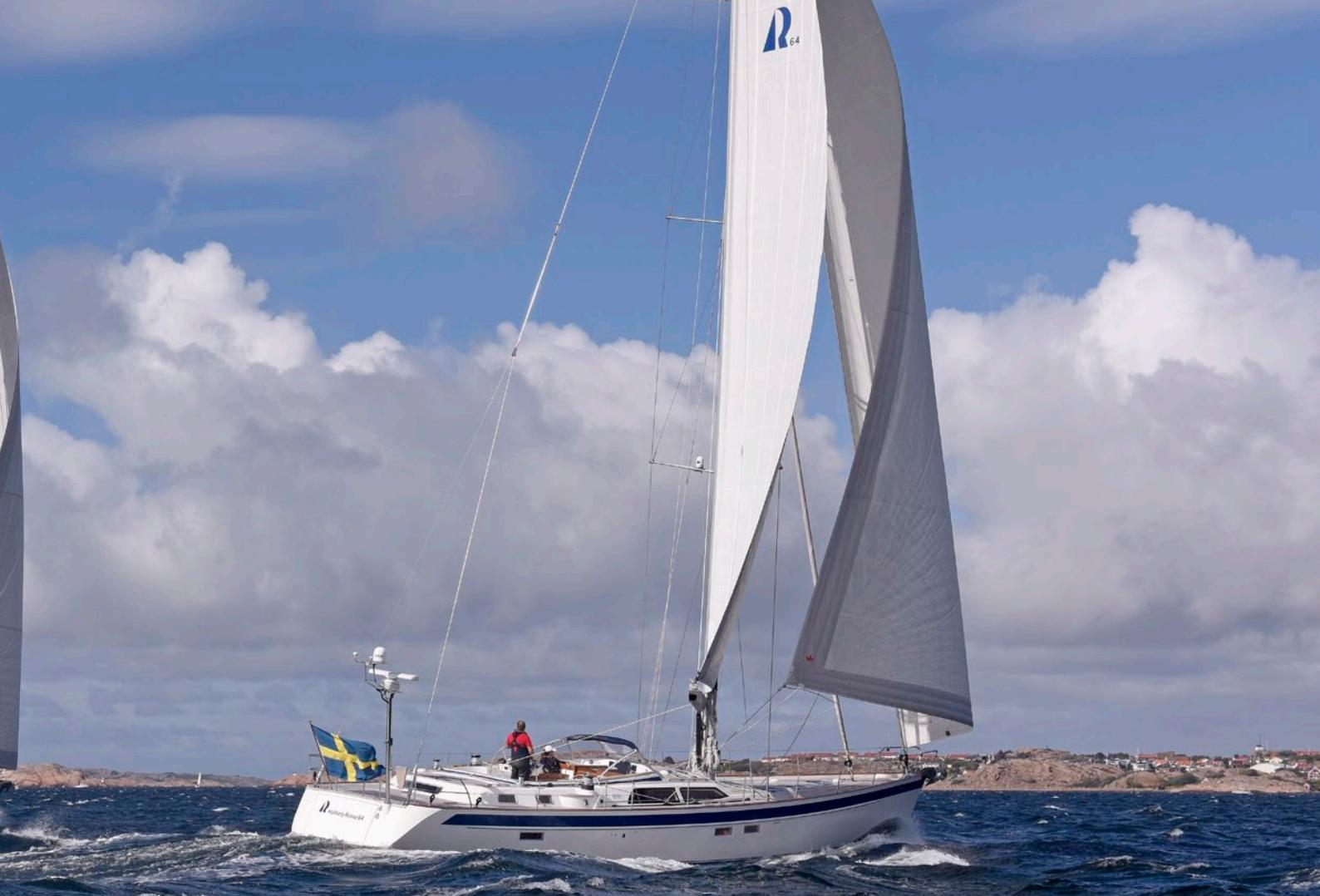
Diese zwei Hallberg-Rassy 64 sind mit Rollsegeln ausgerüstet, die per Knopfdruck vom Cockpit aus gesetzt und eingestellt werden können
