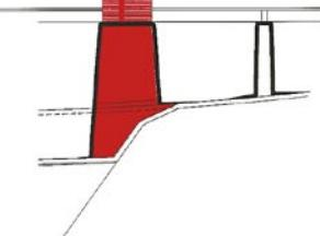
Der Mast wird von einer sehr kräftigen Stütze, sowie auch von einem quer in der Bodenwrange eingegossenen Stahlbalken abgefangen.
