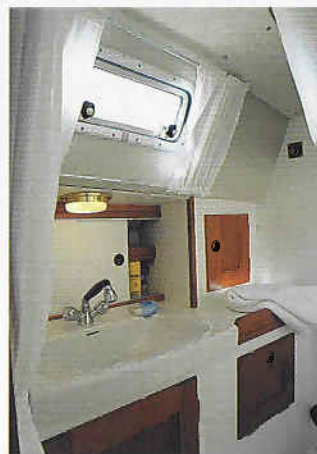
Oben rechts: auch die HR 34 hat einen vollwertig ausgerüsteten Waschraum in Resopal mit Porzellanwaschbecken, warm und kalt Wasser, und einem Duschwasserablauf direkt über Bord, wie auf allen größeren HR-Yachten. 2 Fenster lassen sich für effektive Lüftung öffnen.
