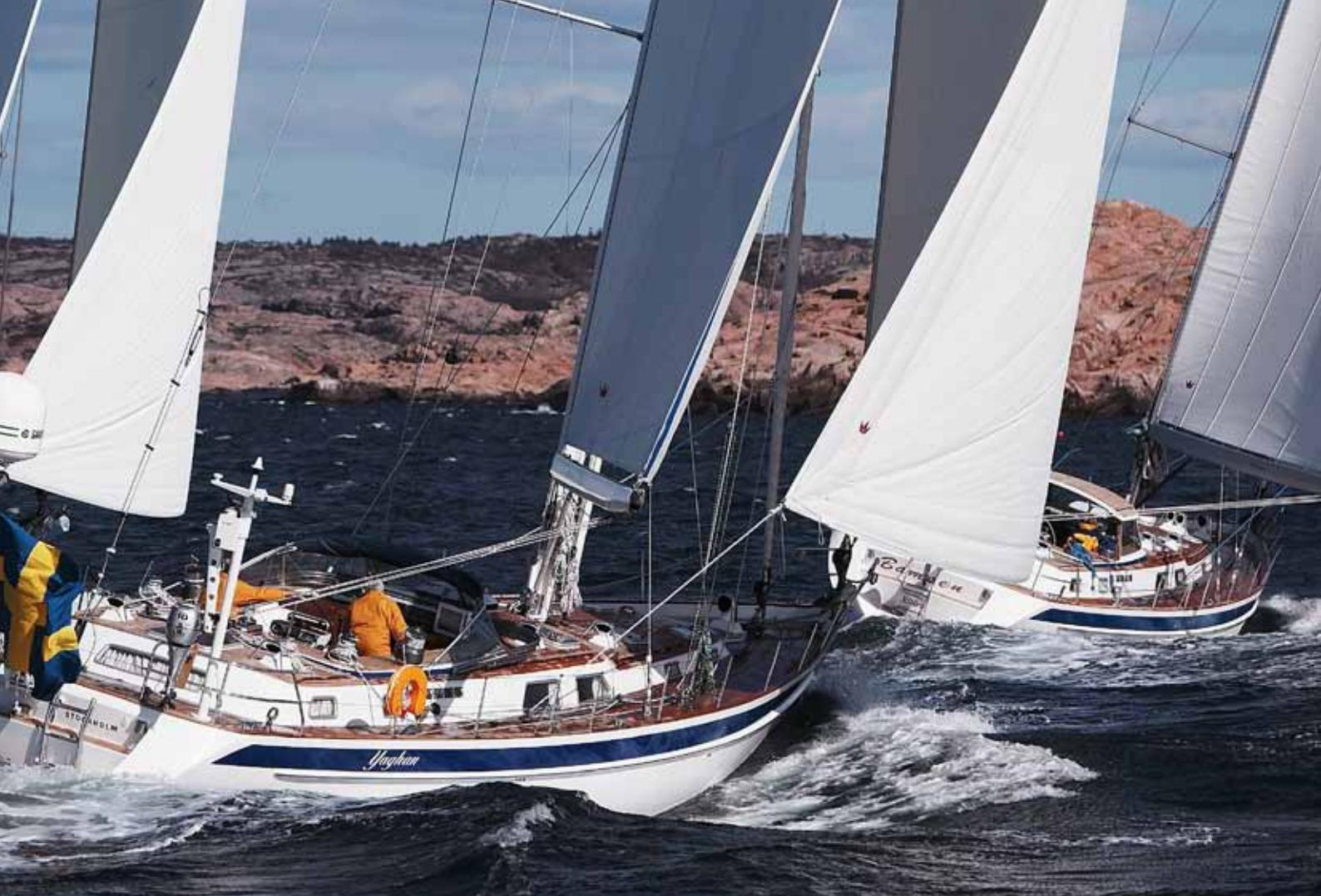
Diese drei HR 62 sind mit Rollsegeln ausgerüstet, die per Knopfdruck vom Cockpit aus gesetzt und eingestellt werden können
